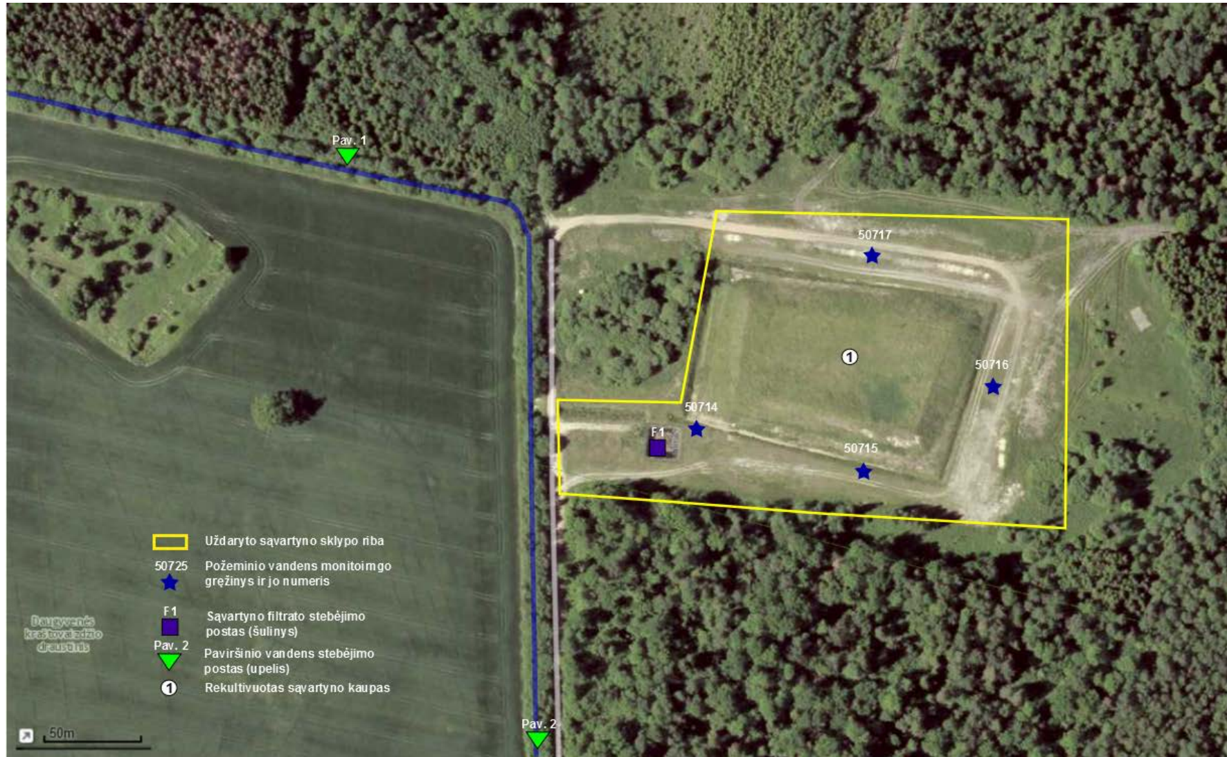
3 pav. Uždaryto Šeduvos sąvartyno teritorijos eksplikacija su aplinkos monitoringo postų išdėstymu
